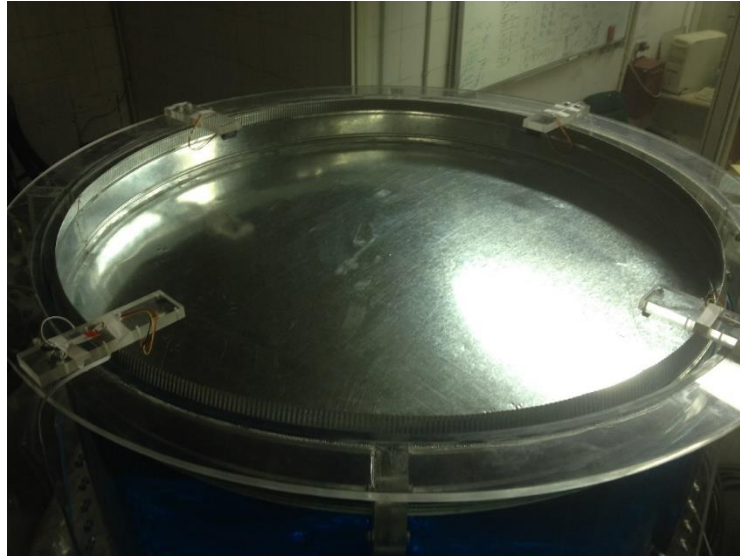
شکل ۴-۲ قرار گرفتن سقف شناور بر روی سیال در مخزن و موقعیت قرار گیری سنسورها جهت اندازه گیری جابه جایی سقف
