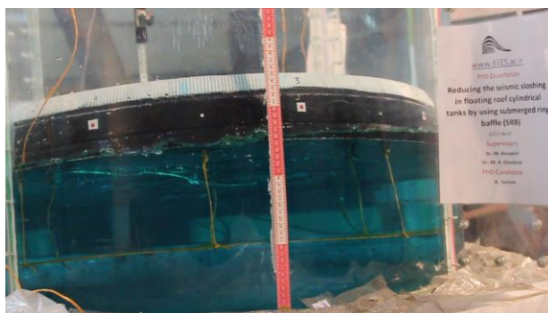
شکل ۲۴-۰ لحظه و مقدار حداکثر پاسخ از دید دوربین چهارم، بار اول تحریک، ۲۵ سانتیمتر
