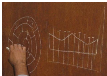
شکل ۹-۰ قرار گرفتن سقف تاج شکل مخزن بر روی پایه های سقف LEG
