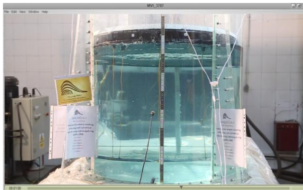
شکل ۷۶-۰ لحظه و مقدار حداکثر پاسخ از دید دوربین دوم، بار دوم تحریک، ۷۶ سانتیمتر
