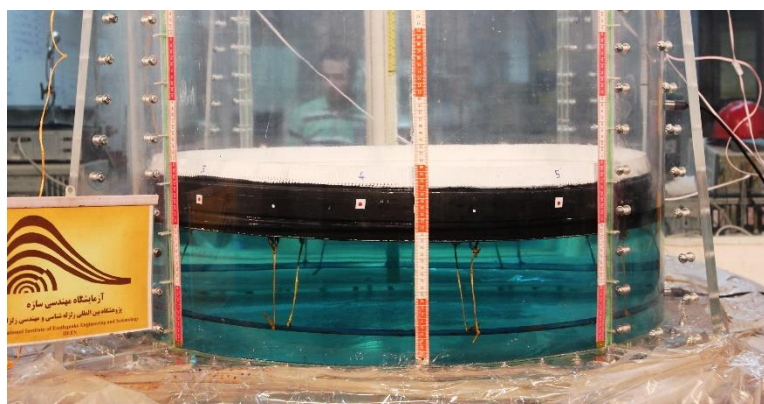
شکل ۱۴-۲ نمای آزمایش از دید دوربین یک در سه ارتفاع مختلف قرار گیری سقف شناور ۲۰، ۵۰ و ۷۰ سانتیمتر. جهت تشخیص بهتر، هر ۱۰ سانتیمتر رنگ متر چسبانده شده روی دیواره تغییر می کند
