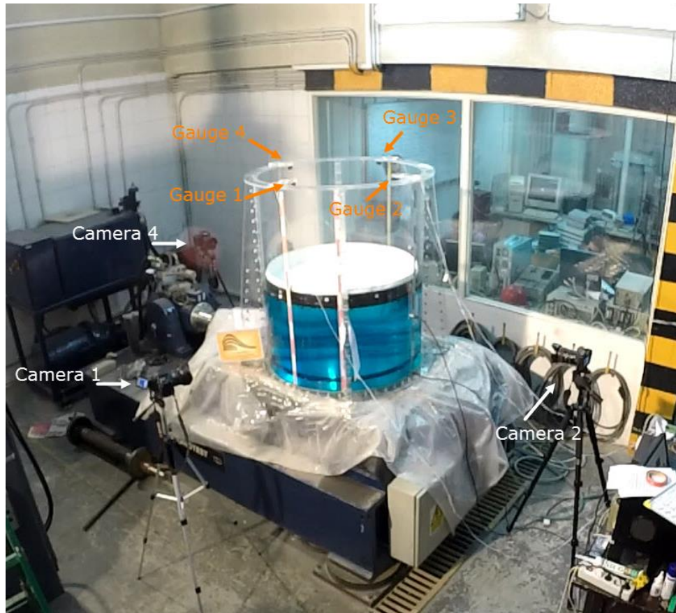
شکل ۲-۵ تصویر مخزن از دید دوربین دید پرنده، شامل جانمایی چهار دوربین و چهار سنسور در آزمایش
