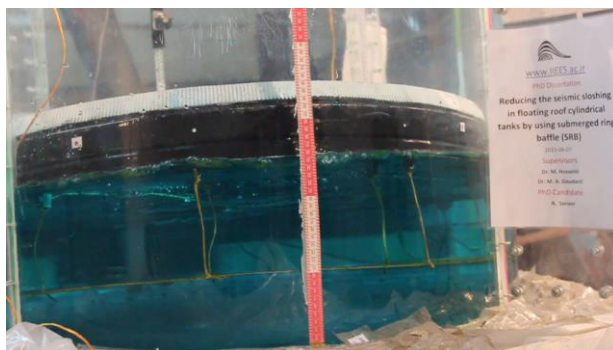
شکل ۲۵-۰ لحظه و مقدار حداکثر پاسخ از دید دوربین چهارم، بار دوم تحریک، ۲۵.۵ سانتیمتر
