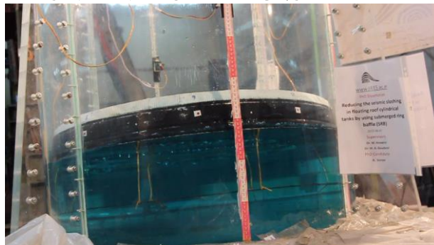
شکل ۱۴- ۰ لحظه و مقدار حداکثر پاسخ از دید دورین چهارم، بار سوم تحریک، ۲۷ سانتیمتر
