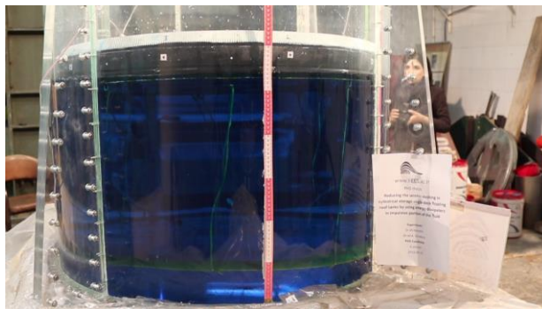
شکل ۶۴- لحظه و مقدار حداکثر پاسخ از دید دوربین چهارم، تحت تحریک هارمونیک با دامنه ۸ میلی متر و فرکانس ۰.۹۳ هرتز، ۵۲ سانتیمتر
