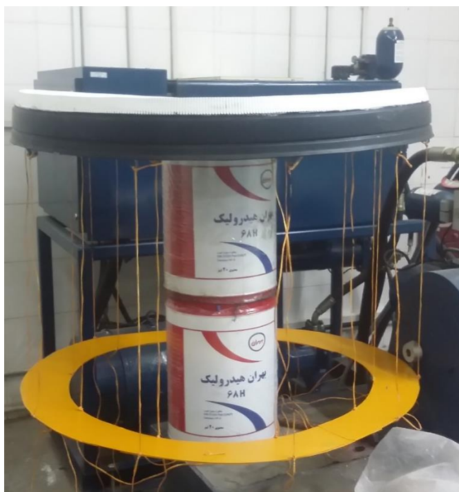
شکل ۲-۸ آویختن بافل حلقوی به عرض ۱۱ سانتیمتر از سقف شناور بیرون از مخزن
