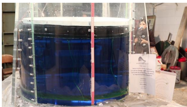
شکل ۶۵- لحظه و مقدار حداقل پاسخ از دید دوربین چهارم، تحت تحریک هارمونیک با دامنه ۸ میلی متر و فرکانس ۰.۹۳ هرتز، ۴۶ سانتیمتر
