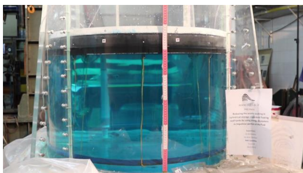
شکل ۴۹- لحظه و مقدار حداقل پاسخ از دید دوربین چهارم، تحت تحریک هارمونیک با دامنه ۲ میلی متر و فرکانس ۰.۹۳ هرتز، ۴۸.۵ سانتیمتر
