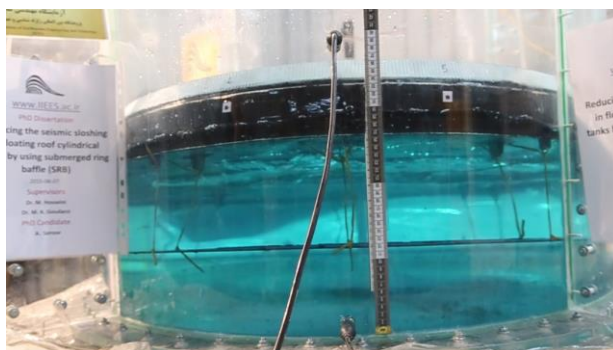
شکل ۱۰-۰ لحظه و مقدار حداکثر پاسخ از دید دورین دوم، بار سوم تحریک، ۲۶.۵ سانتیمتر
