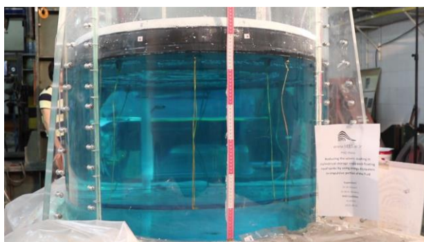
شکل ۵۲- لحظه و مقدار حداکثر پاسخ از دید دوربین چهارم، تحت تحریک هارمونیک با دامنه ۸ میلی متر و فرکانس ۰.۹۳ هرتز، ۵۵ سانتیمتر
