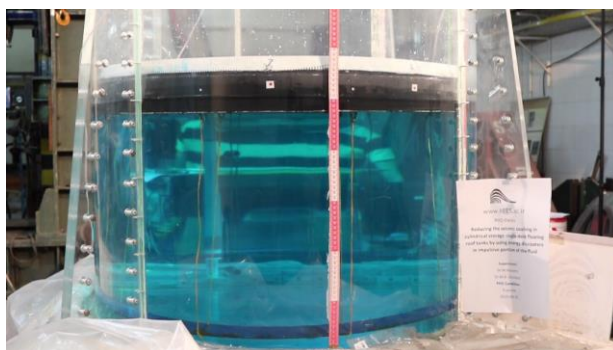
شکل ۵۱- لحظه و مقدار حداقل پاسخ از دید دوربین چهارم، تحت تحریک هارمونیک با دامنه ۴ میلی متر و فرکانس ۰.۹۳ هرتز، ۴۷.۵ سانتیمتر
