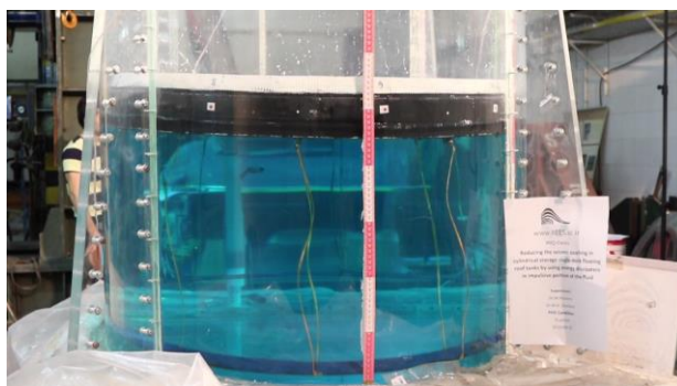
شکل ۵۳- لحظه و مقدار حداقل پاسخ از دید دوربین چهارم، تحت تحریک هارمونیک با دامنه ۸ میلی متر و فرکانس ۰.۹۳ هرتز، ۴۵ سانتیمتر
