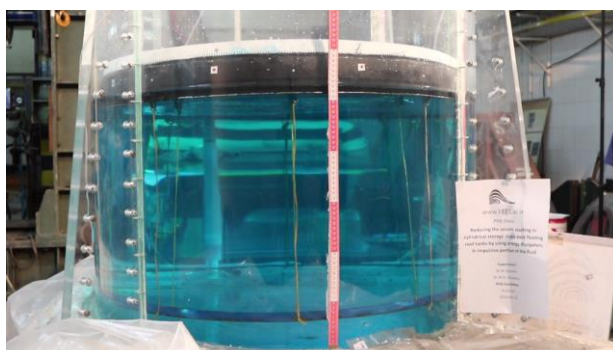
شکل ۴۸- لحظه و مقدار حداکثر پاسخ از دید دوربین چهارم، تحت تحریک هارمونیک با دامنه ۲ میلی متر و فرکانس ۰.۹۳ هرتز، ۵۱.۵ سانتیمتر
