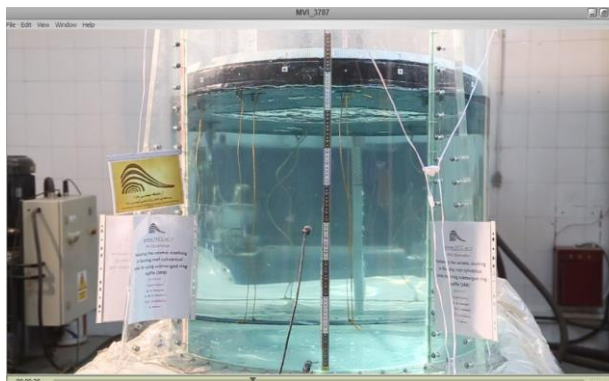
شکل ۷۵-۰ لحظه و مقدار حداکثر پاسخ از دید دوربین دوم، بار اول تحریک، ۷۶.۵ سانتیمتر
